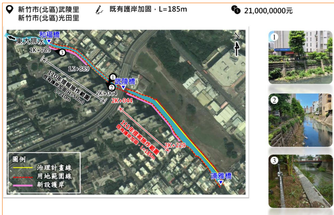
圖 2-16 東大排水(河心累距 2K+044~2K+229)護岸改善應急工程環境現況圖
