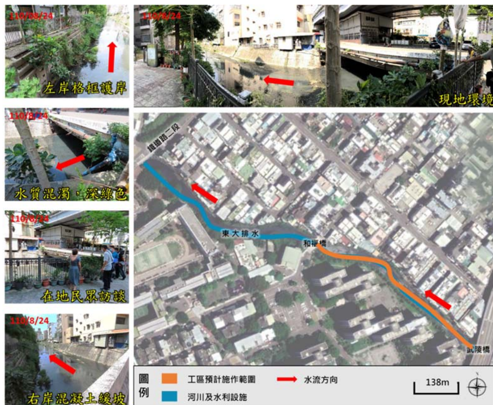
圖 16 東大排水(河心累距 1K+789~2K+004)護岸改善應急工程環境現況圖
