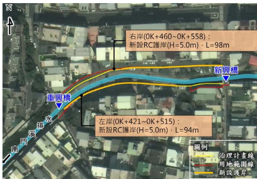
圖 1 南門溪排水(河心累距 0K+421~0K+558)護岸改善應急工程工區位置圖
